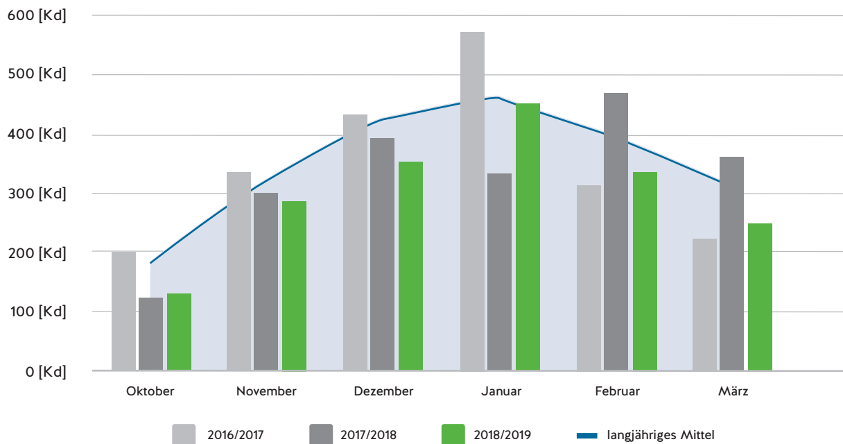
Abbildung 1 - Heizgradtage im Winter 2018/2019 (Wärmebedarf)
